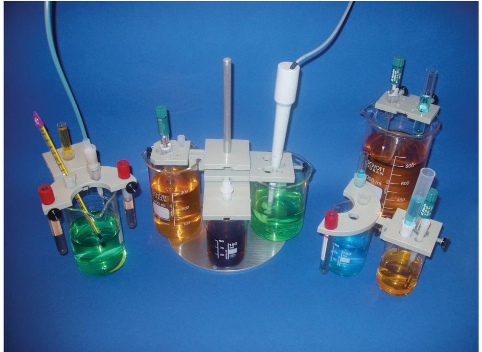
Das Grundmodul ist so konzipiert, dass es auf die verschiedenen Durchmesserbereiche (>10 mm) passt. Das sichere Klemmen auf dünnwandigem Glas bis hin zu metallischen Behältern ist dabei problemlos möglich. Im Weiteren eignet sich das System hervorragend als Zubehöroption für Wannenträger, Heizbäder, Aquarien, Stativergänzungen und sonstige Behälter.
